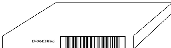
Figura 8 – Posizionamento dei codici: codice centrato sul lato verticale dell'imballo
