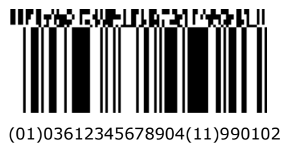
Figura 5.11.8-6. Simbolo GS1 DataBar Stacked con due colonne CC-A
