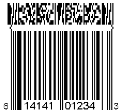
Figura 5.11.8-2. Simbolo UPC-A con Component CC-B a quattro colonne
