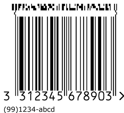
Figura 5.11.8-2. Simbolo UPC-A con Component CC-B a quattro colonne
