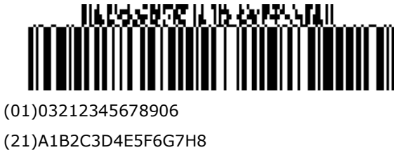
Figura 5.11.8-9. Simbolo GS1-128 con quattro colonne CC-A
