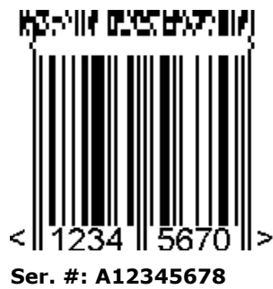
Figura 5.11.8-4. Simbolo UPC-E con CC-A a due colonne
