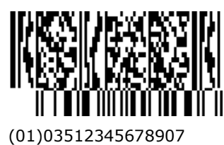
Figura 5.11.8-7. GS1 DataBar Limited con tre colonne CC-B
