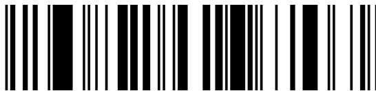
Figura 5.5.2.3.1-1. Simbolo GS1 DataBar Expanded
