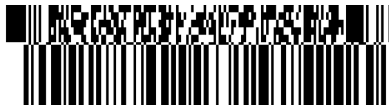
Figura 5.11.2-2. Simbolo Composite con GS1-128 con CC-C
