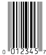
Figura 5.2.1.2.24 -1. Simbolo UPC-E (codificando 00123400057 attraverso la soppressione degli zero)
