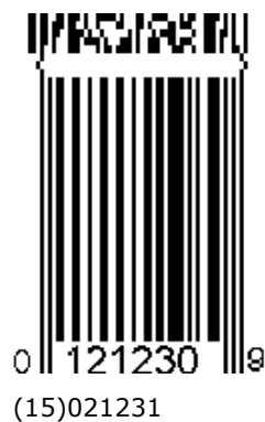
Figura 5.11.8-5. GS1 DataBar-14 con quattro colonne CC-A
