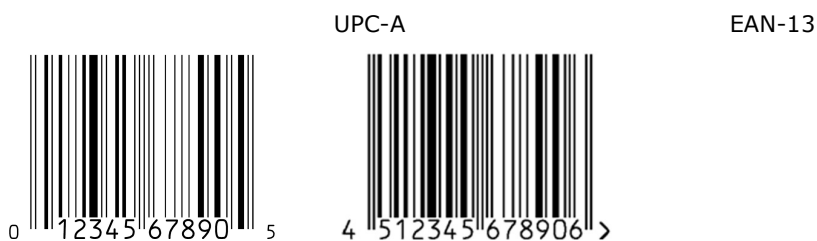
Figura 5.1-1. Codici a barre EAN-13 e UPC-A
