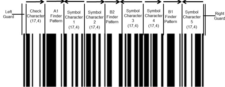
Figura 5.5.2.3-1. Struttura del GS1 DataBar Expanded
