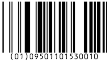
Figura 5.1-4. Codice a barre GS1 DataBar Omnidirectional
