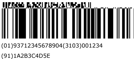
Figura 5.11.8-9. Simbolo GS1-128 con quattro colonne CC-A
