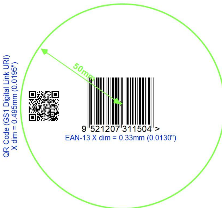
Figura 6.3.3.1-1: Posizionamento del codice a barre 2D rispetto al codice a barre lineare
