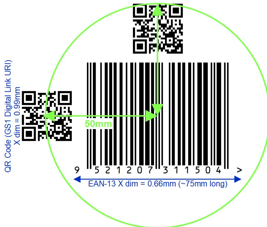
Figura 6.3.3.1-4: Esempio di posizionamento del codice a barre 2D rispetto al codice a barre lineare con massima X-dimension
