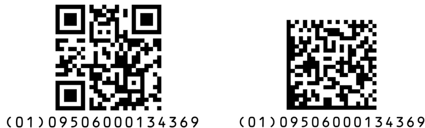
Figura 2.1.13.1-1: Esempi di QR Code e Data Matrix con sintassi GS1 DL URI
