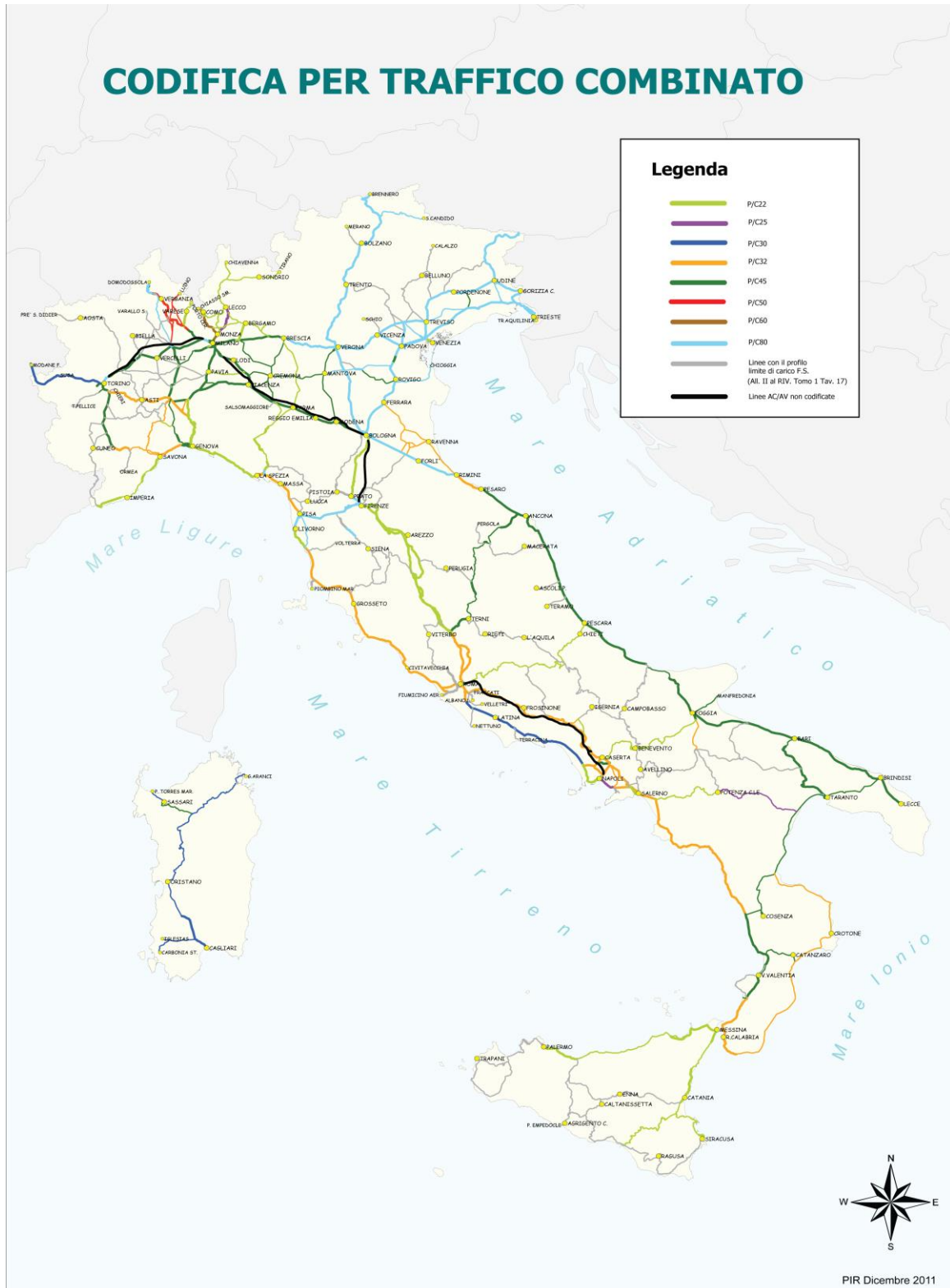
Figura 2: Codifica del profilo sagoma limite per Trasporto combinato, planimetria da "Prospetto Informativo della Rete", RFI, edizione dicembre 2011 4
