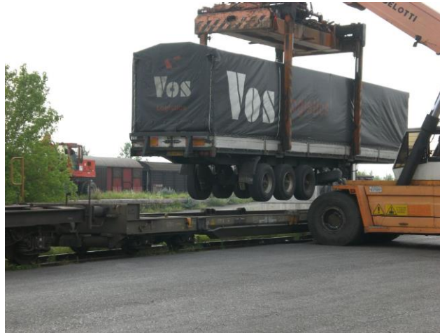
Figura 22: esempio di caricamento semirimorchio su carro Poche
