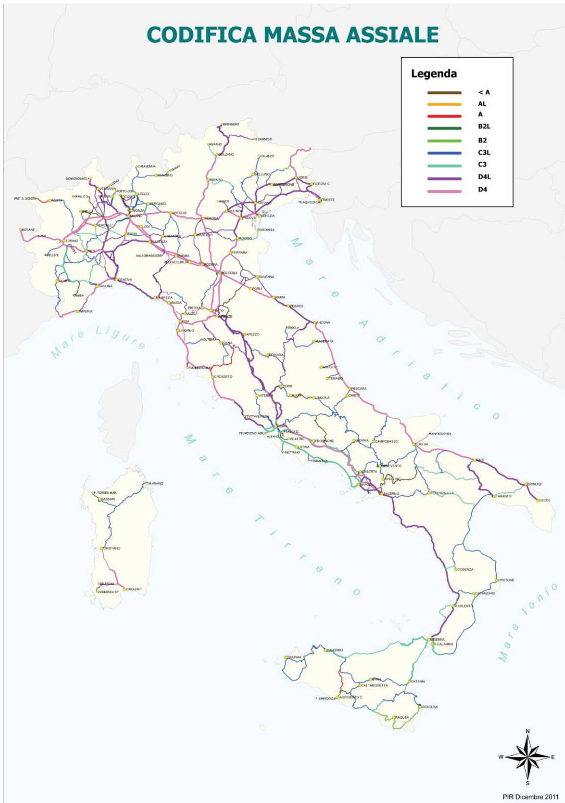
Figura 4: Codifica per Massa assiale, planimetria da “Prospetto Informativo della Rete”, RFI, edizione dicembre 2011 5
