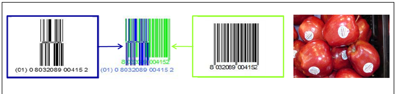
Figura 4: Confronto tra GS1 DataBar Omnidirectional Stacked ed EAN-13 per la codifica dei prodotti di piccole dimensioni
