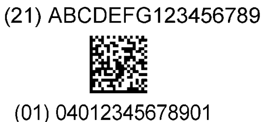
Figure 2.1.4-4. Esempio di simbolo GS1 DataMatrix codificato con GTIN e Numero Seriale AI (21)
