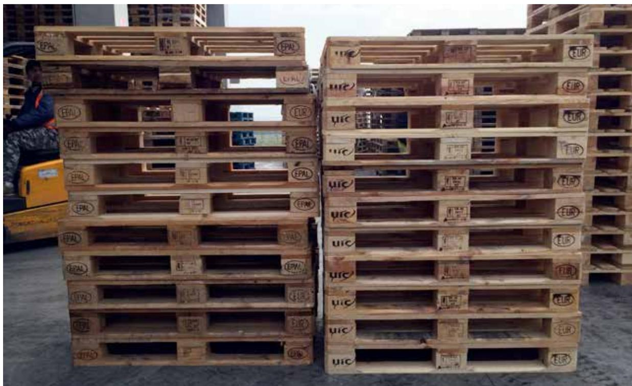
Figura 1.7 - Differenza di spessore tra i pallet EPAL-EPAL e i pallet UIC-EUR
