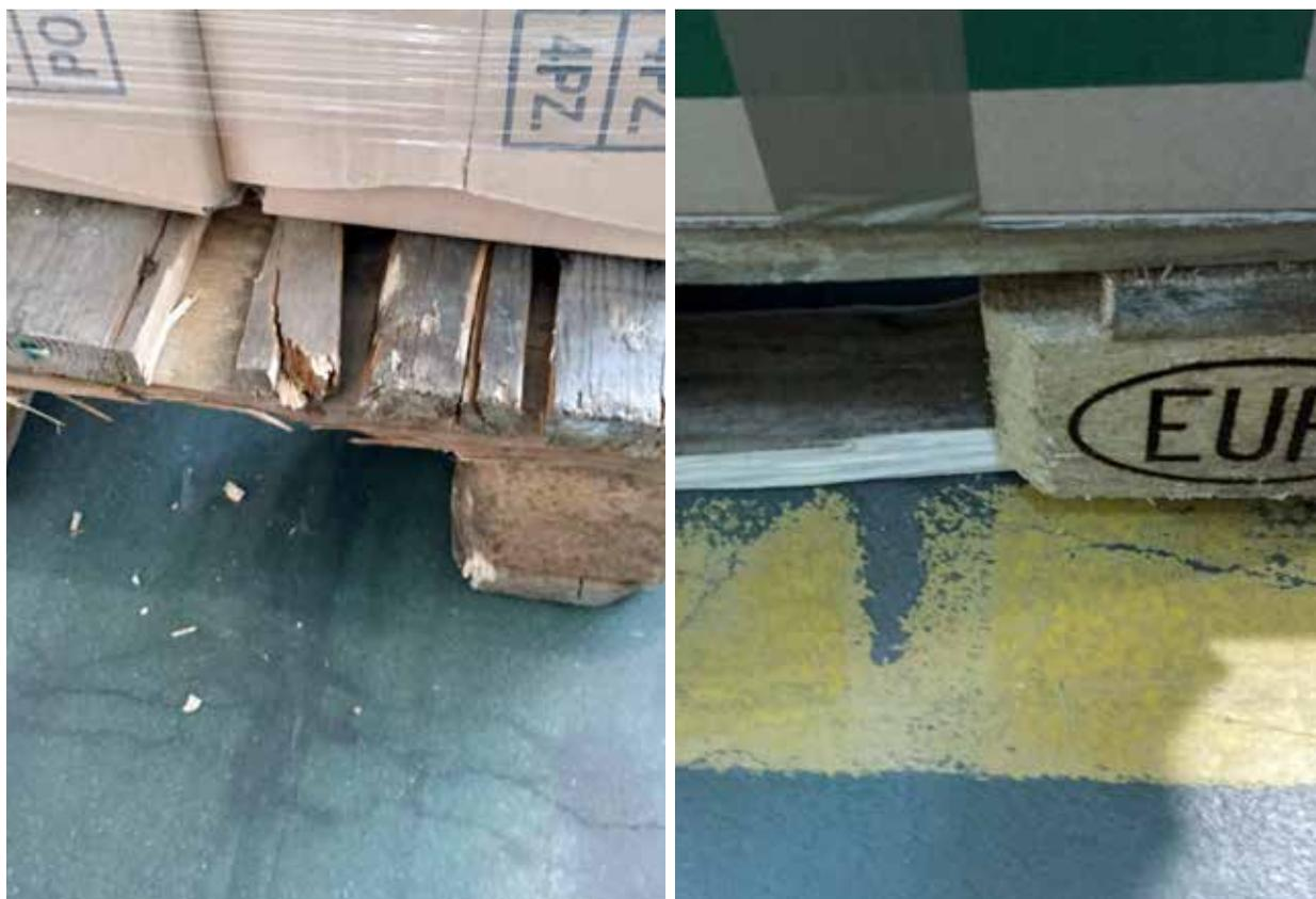
Figura 3.13 - Tavola inferiore del pallet rovinata, che influenza la capacità di carico statico del bancale stesso
