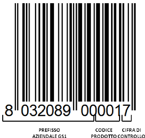
Figura 4 – Simbologia di stampa EAN-13 di un codice GTIN-13
