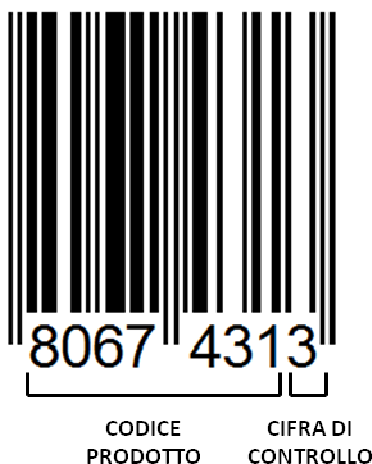
Figura 5 – Simbologia di stampa EAN-8 di un codice GTIN-8
