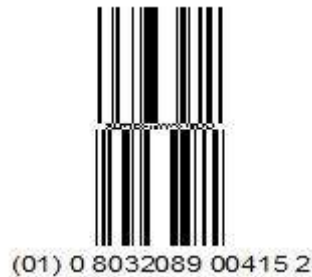
Figura 9 – Rappresentazione della simbologia GS1 DataBar
