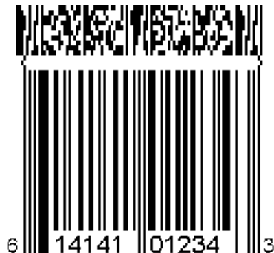
Figura 5.11.8-3. Simbolo EAN-8 con CC-A a tre colonne
