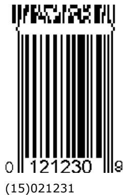
Figura 5.11.8-5. GS1 DataBar-14 con quattro colonne CC-A
