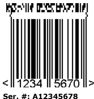
Figura 5.11.8-3. Simbolo EAN-8 con CC-A a tre colonne
