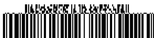
Figura 5.11.8-9. Simbolo GS1-128 con quattro colonne CC-A
