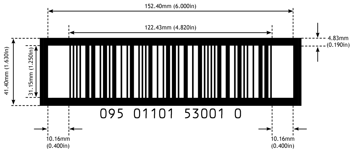
Figura 5.3.6-1. ITF-14 Symbol: Dimensione principale a fattore d'ingrandimento 1,016 mm (0.040 pollici)
