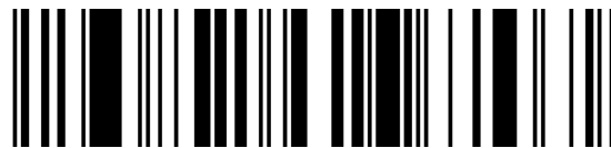
Figura 5.5.2.3.1-1. Simbolo GS1 DataBar Expanded
