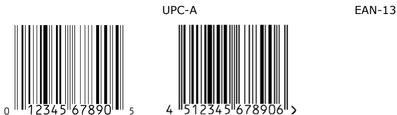
Figura 5.1-1. Codici a barre EAN-13 e UPC-A
