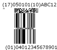
Figura 5.1-5. Codice a barre GS1 Databar Omnidirectional Stacked con Composite Component
