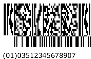
Figura 5.11.8-7. GS1 DataBar Limited con tre colonne CC-B
