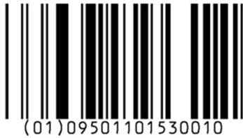
Figura 5.1-4. Codice a barre GS1 DataBar Omnidirectional
