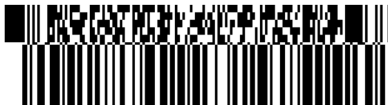
Figura 5.11.2-2. Simbolo Composite con GS1-128 con CC-C
