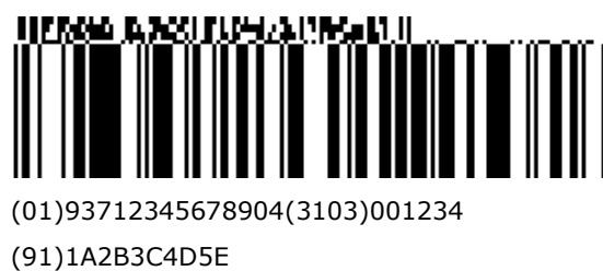
Figura 5.11.8-9. Simbolo GS1-128 con quattro colonne CC-A
