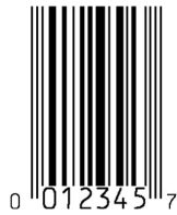
Figura 5.2.1.2.24 -1. Simbolo UPC-E (codificando 001234000057 attraverso la soppressione degli zero)
