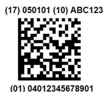
Figura 5.1-6. Codice a barre GS1 DataMatrix
