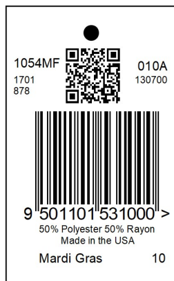
Figura 6.3.3.1-3: Esempio di posizionamento del codice a barre 2D rispetto al codice a barre lineare, su etichetta appesa
