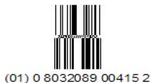
Figura 2.2: GS1 DataBar Omnidirectional Stacked per l'identificazione di prodotto
