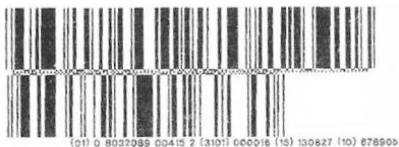
Figura 4.2: Codice GS1 DataBar Expanded Stacked per applicazioni di tracciabilità, con X-dimension massima
