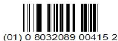
Figura 2.1: GS1 DataBar Omnidirectional per l'identificazione di prodotto
