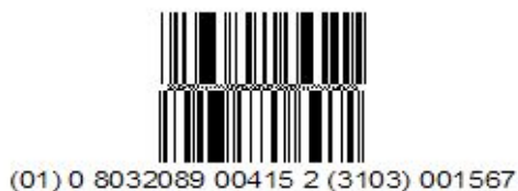
Figura 2.4: GS1 DataBar Expanded Stacked per pesi variabili
