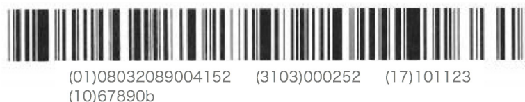
Figura 4.1: Codice GS1 DataBar Expanded per applicazioni di tracciabilità
